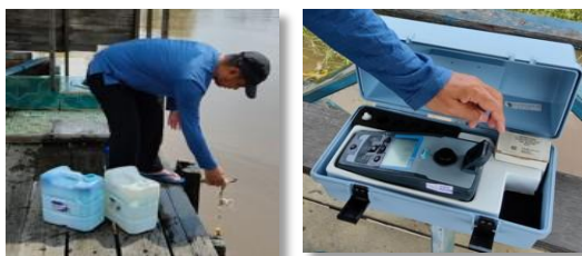
Gambar 1. Pengukuran pH dan Kekeruhan Air
