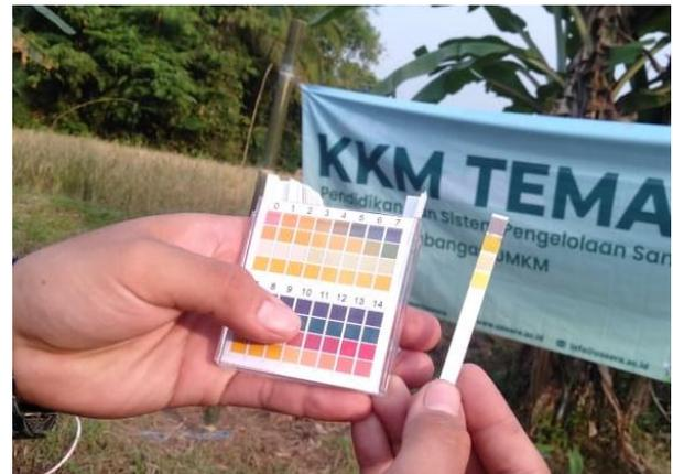
Gambar 10. Hasil Pengukuran Ph Air Kolam Dengan Kertas Lakmus
