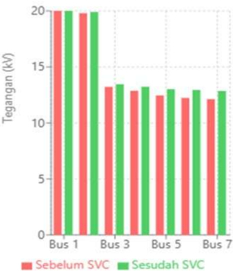
Gambar 4. Grafik Perbandingan Profil Tegangan Sebelum dan Sesudah SVC
