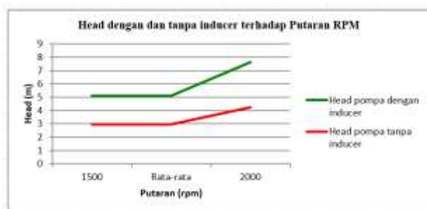
Gambar 1. Hasil perhitungan Head pada pompa sentrifugal dengan penambahan turbulence inducer dan tanpa turbulence inducer
